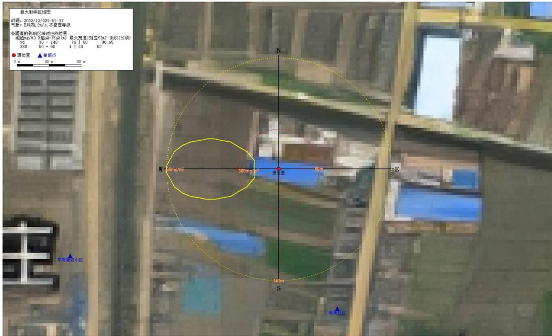
图 5.8-5 聚氨酯胶水泄漏火灾事故发生最大影响区域图
