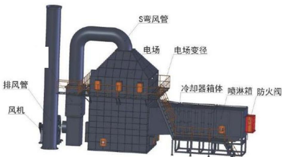
图 6.2-4 “水喷淋+静电净化”设备示意图
